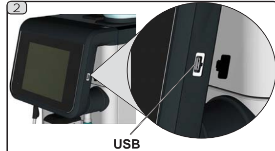
2 Вставьте USB-накопитель с изображениями в выделенный разъем, расположенный справа от сенсорного экрана.
