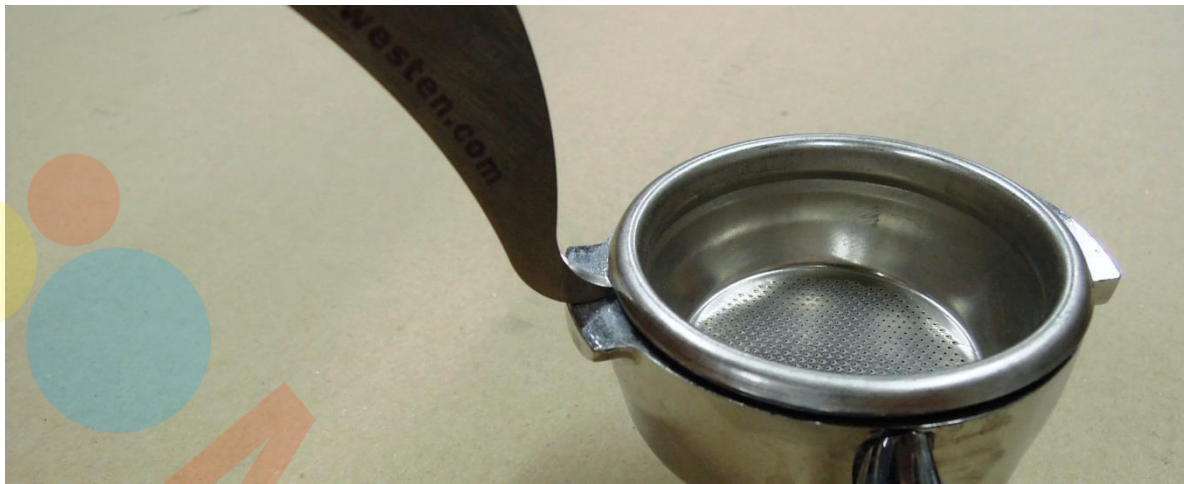
Рис. 15. Снимите корзину фильтра с фильтродержателя с помощью экстрактора группового экрана.
