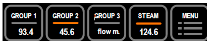
Рис.20. Отчет об ошибке, если расход во время заваривания выходит за пределы диапазона расходомера.
